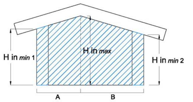
Volume =  $[SUL\ A \times \frac{(H_{in\ max} + H_{in\ min\ 1})}{2}] + [SUL\ B \times \frac{(H_{in\ max} + H_{in\ min\ 2})}{2}]$
